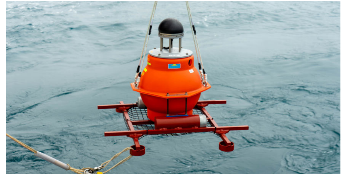
図1. GNSS-A観測用の海底局設置時の様子。海上の船舶等との距離は音響測距で行います。
